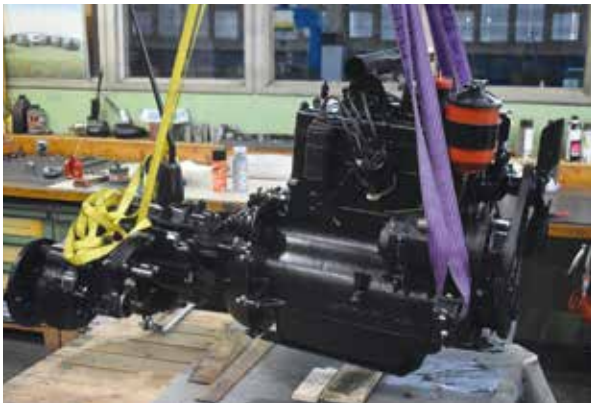
Abb. 3: Wie neu: Der Motor mit Getriebe nach der Restaurierung.
