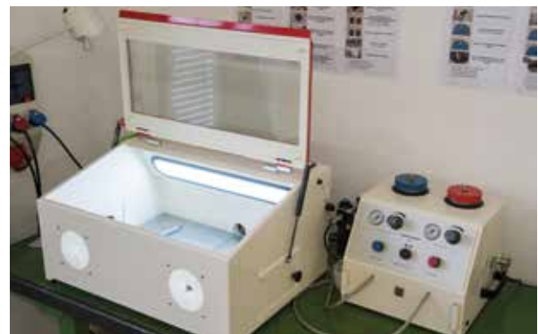
Abb. 2: Arbeitskabine und Strahlgerät für die Bearbeitung empfindlicher Materialien.
